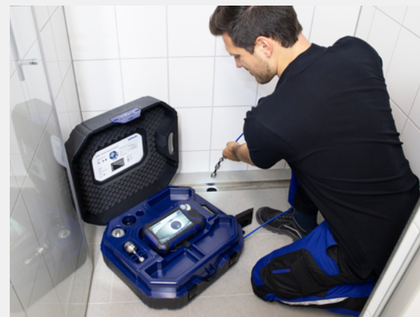
Vodonepropusna glava kamere omogućuje, između ostalog, pregled kanalizacije.
