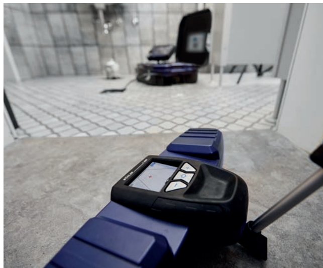
Precizno lociranje glave kamere s Wöhler L 200 Lokatorom
