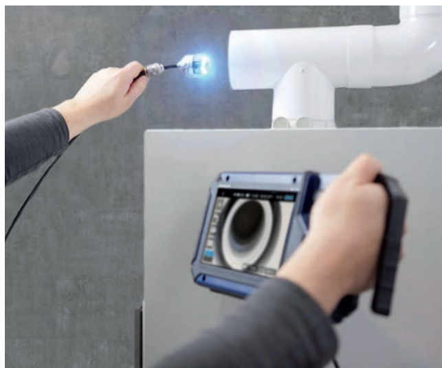
Ispitivanje dimovoda od Ø 56 mm: lako prolazi uske zavoje od 87 °
