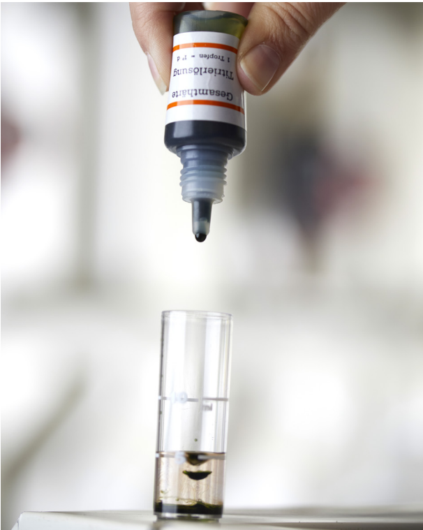
Jednostavno odredite stupanj tvrdoće Vrlo jednostavno i pouzdano određivanje stupnja tvrdoće s titracijskom otopinom koja je uključena u isporuci.
