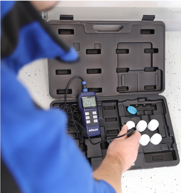
Sve u jednom koferu Osim mjernog uređaja, set sadrži i sve potrebne otopine i sonde za određivanje električne vodljivosti, pH vrijednosti i tvrdoće vode za grijanje.
