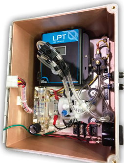
Unutrašnjost DCC-SD, prikazuje LPT-A detektor plina sa toksičnim, zapaljivim ili rashladnim senzorom na desnoj strani kućišta.
